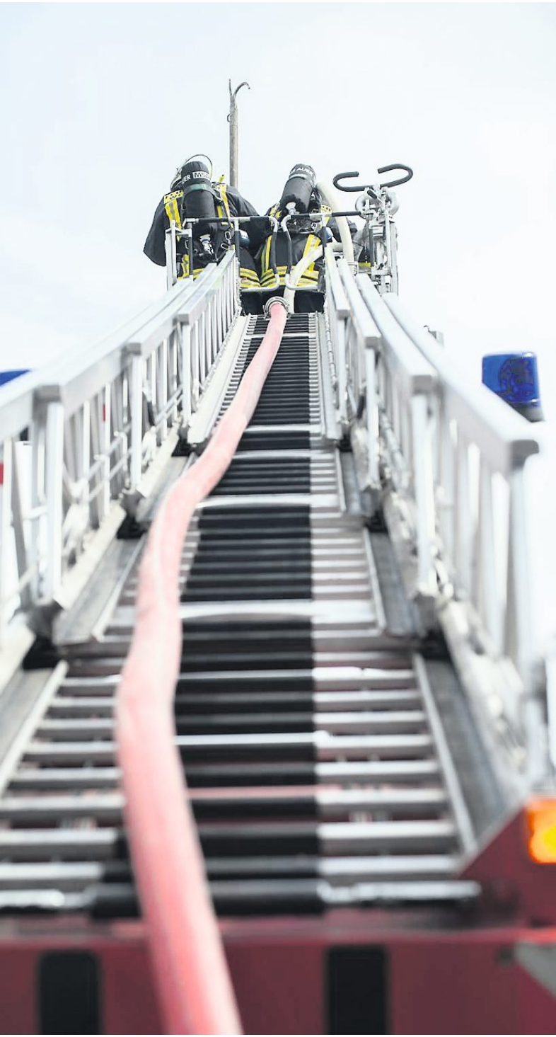
Die Drehleiter der Freiwilligen Feuerwehr Weinheim, Abteilung Stadt, hat 25 Jahre auf dem Buckel. Das 16 Tonnen schwere Fahrzeug soll dieses Jahr für 680 000 Euro durch ein neues ersetzt werden. Im Herbst wird die Lieferung der neuen Drehleiter mit einer Rettungshöhe von 23 Metern erwartet. Sie soll über einer Dachspitze abgeklappt werden können, so dass man von ihr aus auch auf der Rückseite löschen kann.
